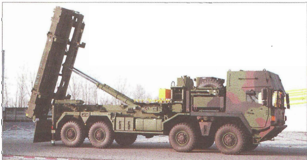
Пусковая установка ЗРК МЕАДС
