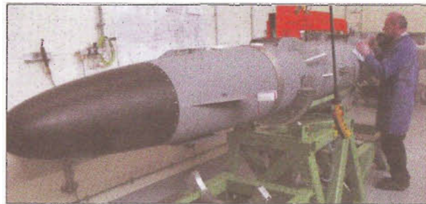
На фотоверху – ПКР RBS-15 Mk 3 в сборочном цехе; внизу – корабельные пусковые контейнеры ПКР.
