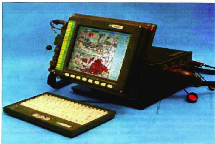
Внешний вид комплекта ЭВМ AN/UYK-128 Applique
